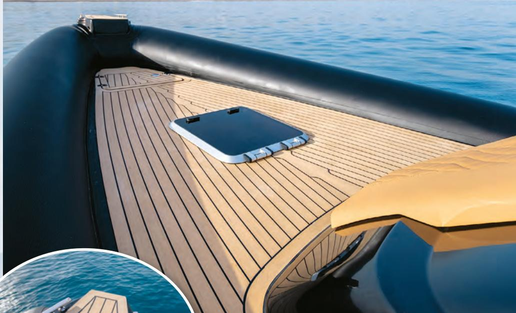
*Il ponte di prua è molto ampio e, quindi, perfettamente sfruttabile. Il musone è minimalista perché l'ancora viene filata attraverso l'occhio di cubia sotto al tubolare. Un portello, inaspettatamente privo di guarnizioni e di un attuatore, consente l'ispezione del verricello (di serie da 700 W) e della catena. Il rivestimento in teak sintetico dona più eleganza al battello e non richiede manutenzione.*
